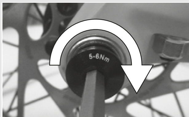
Figura 16: Serraggio della vite di sicurezza
