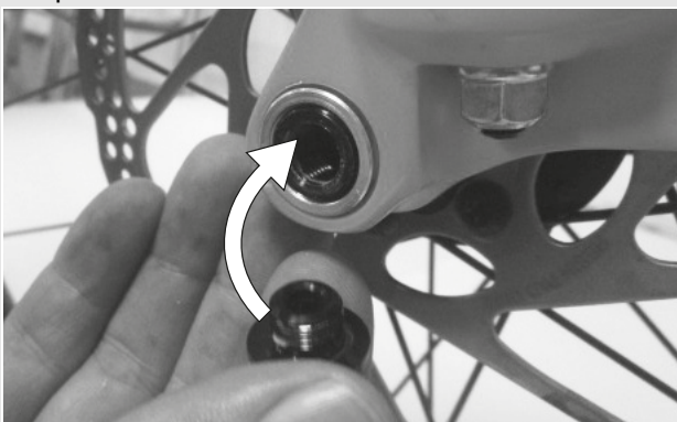
Figura 15: Applicazione della leva del bloccaggio rapido nel perno
