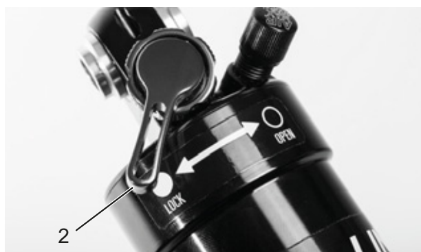
Figura 57: Regolatore dello stadio di pressione Suntour chiuso (2)
