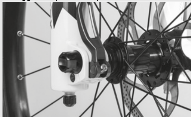
Figura 66: Regolazione della forza di serraggio del bloccaggio rapido
