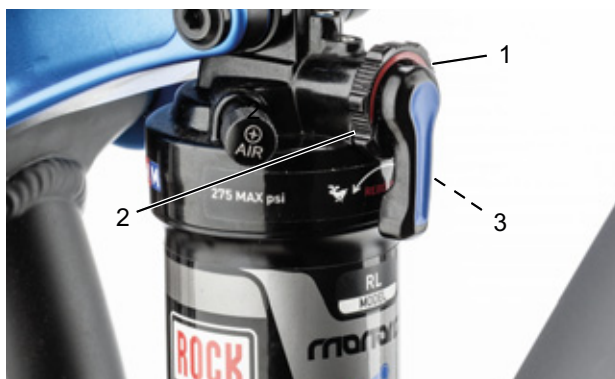
Figura 61: Regolazione della rigidità dell'ammortizzatore a stadi di trazione con la manopola di regolazione (1) dell'ammortizzatore del carro posteriore
