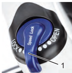
Afbeelding 23: Vorkblokkering op veerkop met blokkeringshendel (1), voorbeeld
