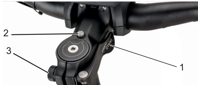
Abbildung 18: Vorbau, Ausführung II mit Spannhebel (1), Entsperrknopf (2) und Rändelmutter (3)
