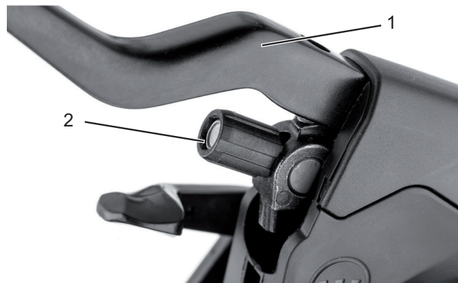
Abbildung 35: Bremshebel (1) der hydraulisch betätigten Felgenbremse mit Einstellschraube (2)
