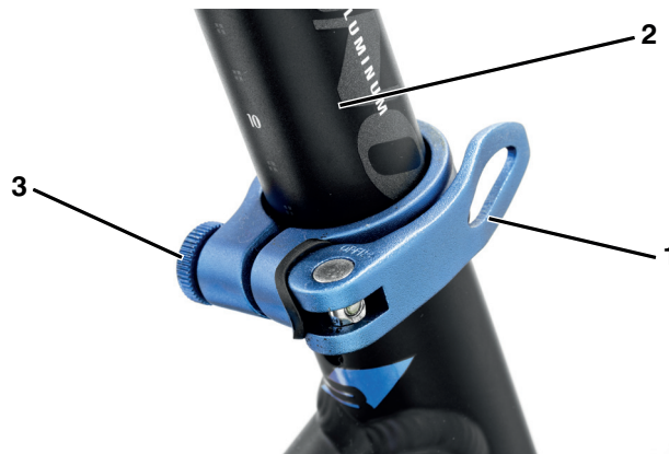
Abbildung 17: Schnellspanner der Sattelstütze in der Endposition
