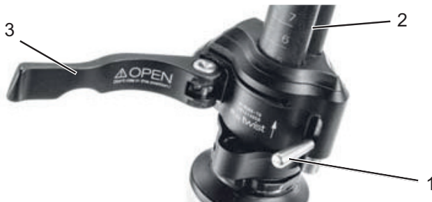
Abbildung 23: Geöffneter Spannhebel des Vorbau-Schnellspanners (3) am Vorbau (2), Ausführung I, mit Sicherungshebel am Vorbau (1)
