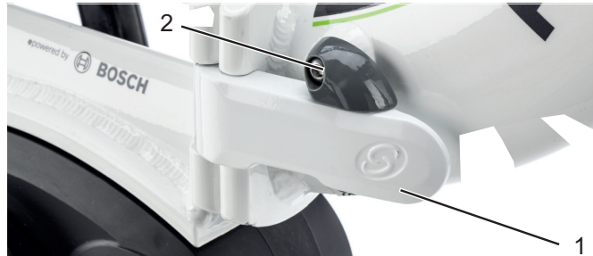
Abbildung 26: Rahmen, mit geschlossenem Rahmen-Spannhebel (1) und geschlossenem Rahmen-Sicherungshebel (2)
