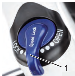
Rysunek 23: Blokada widelca na amortyzatorze dźwignią (1), przykład
