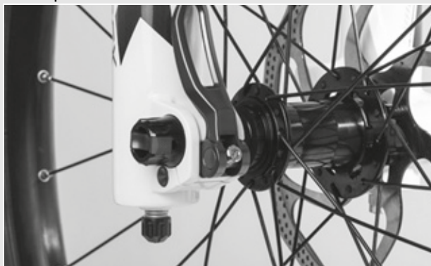
Figura 66: Ajuste de la fuerza de tensado del cierre rápido
