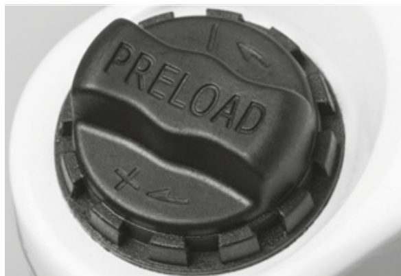
Figura 45: Rueda de ajuste del recorrido de muelle negativo en la corona de la horquilla de suspensión
