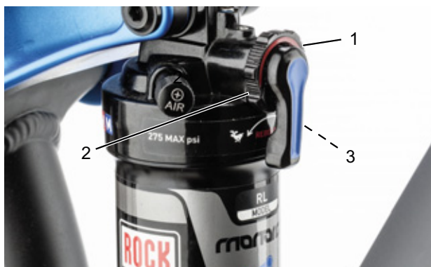
Afbeelding 61: Hardheid van de trekdemper afstellen met het afstelwiel (1) van de achterbouwdemper
