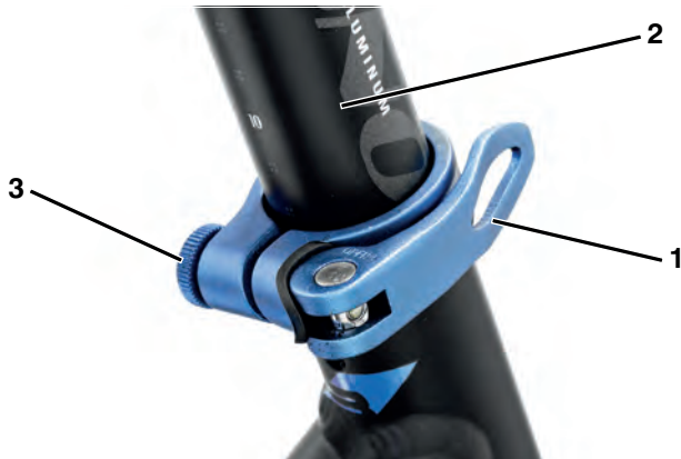
Abbildung 17: Schnellspanner der Sattelstütze in der Endposition
