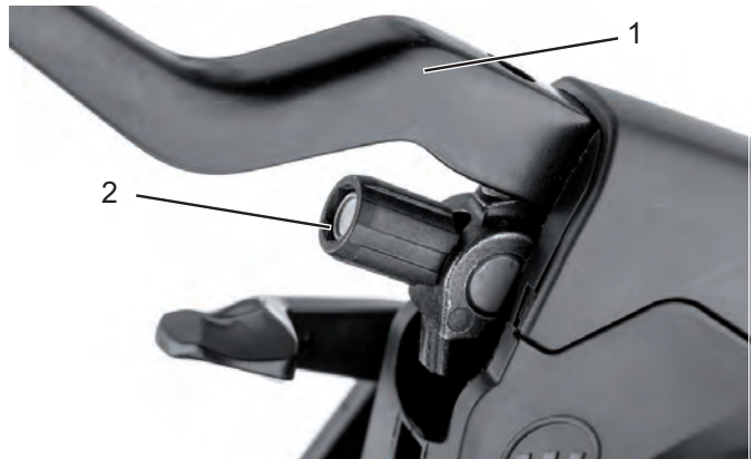
Abbildung 51: Bremshebel (1) der hydraulisch betätigten Felgenbremse mit Einstellschraube (2)
