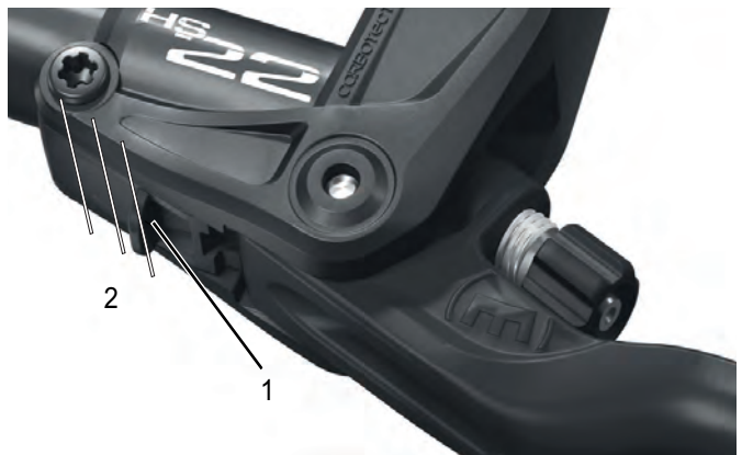
Abbildung 6: Bremshebel mit Schieber (1) und seinen drei Positionen (2)
