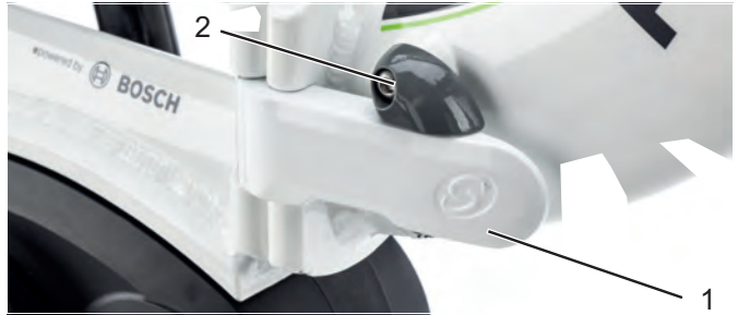
Abbildung 52: Rahmen, mit geschlossenem Rahmen-Spannhebel (1) und geschlossenem Rahmen-Sicherungshebel (2)
