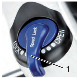
Abbildung 1: Gabelsperre am Federkopf mit Sperrhebel (1), Beispiel
