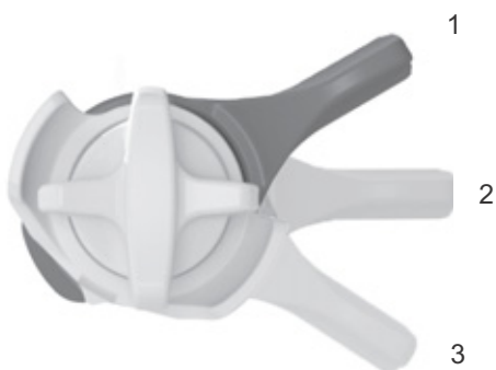
Obr. 59: Nastavovací šroub komprese FOX na tlumiči zadního odpružení s polohami OTEVŘENÁ (1), STŘEDNÍ (2) a TVRDÁ (3)
