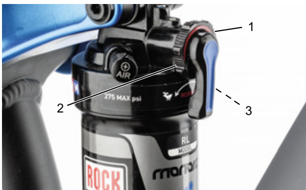
Obr. 61: Nastavení tvrdosti tlumiče odskoku zadního odpružení nastavovacím kolečkem (1)
