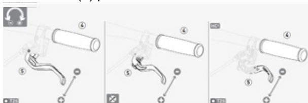
Obr. 43: Nastavení vzdálenosti brzdové páky kotoučové brzdy Magura
