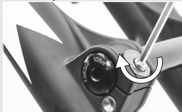
Obr. 18: Utažení pojistné svorky
