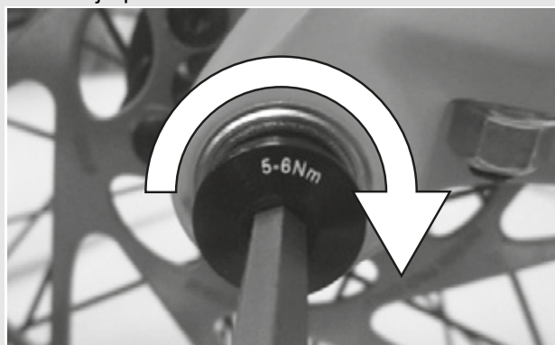
Obr. 16: Utažení pojistného šroubu
