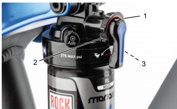
Illustration 61 : Régler la dureté de l'amortisseur de détente via la molette de réglage (1) de l'amortisseur arrière
