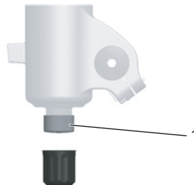
Illustration 48 : Dispositif de réglage de la détente FOX (1) sur l'extrémité de fourche
