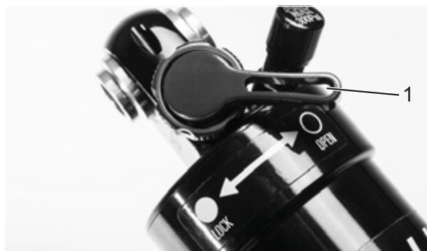
Illustration 56 : Dispositif de réglage de la compression Suntour ouvert (1)
