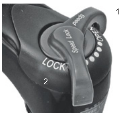
Illustration 55 : Dispositif de réglage de la compression Suntour avec les positions OPEN (1) et LOCK (2)
