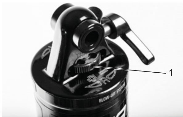
Illustration 49 : Molette de réglage de la détente Suntour (1) sur l'amortisseur arrière
