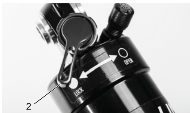
Illustration 57 : Dispositif de réglage de la compression Suntour fermé (2)
