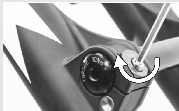
Illustration 18 : Serrer le collier de blocage
