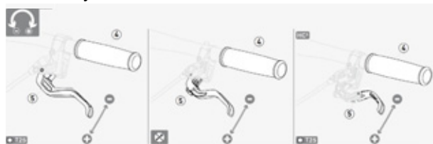
Illustration 43 : Régler la garde d'un levier de frein à disque Magura
