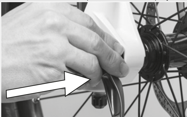
Illustration 26 : Enfoncez l'attache rapide
